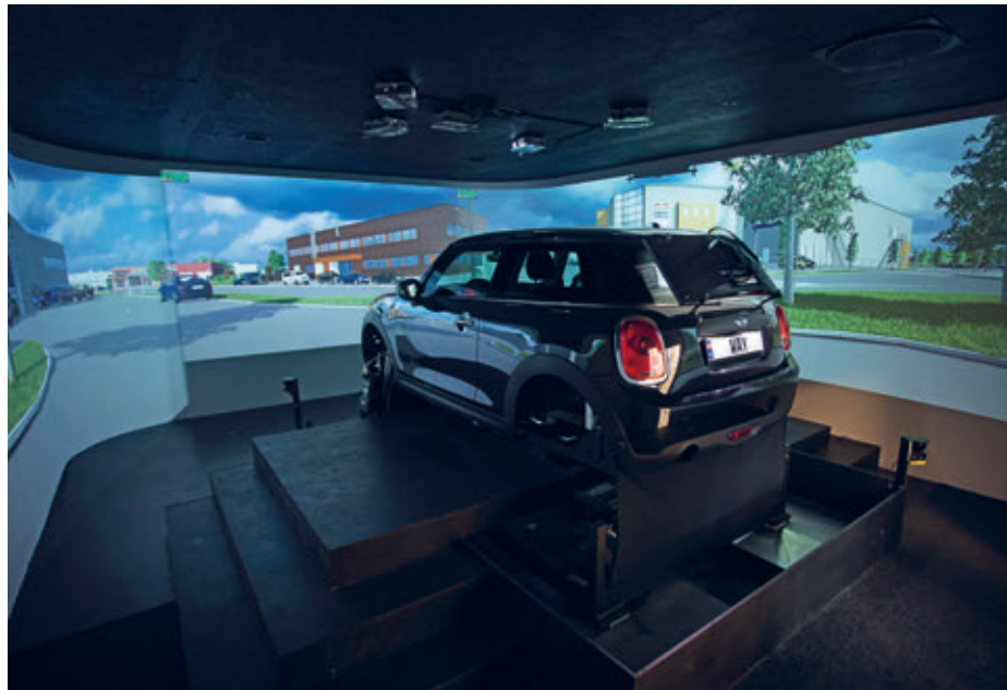
Way-kjøresimulator. Simulatoren består av en faktisk bil montert på en bevegelsesplattform, omgitt av et 360° simulert trafikkbilde. Simulatoren har også en rekke sensorer og kunstig intelligens som støtter analysen. Foto: Way AS
