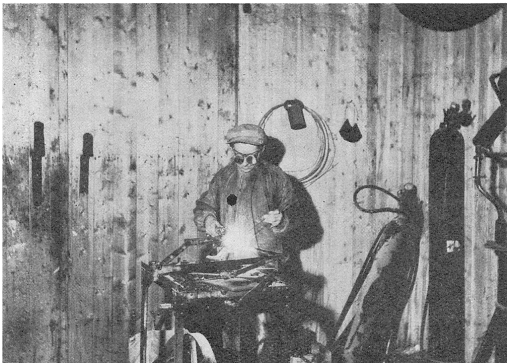
Fra sykkelreparasjonsverksted. Sykkelramme. Autogensveisning.
