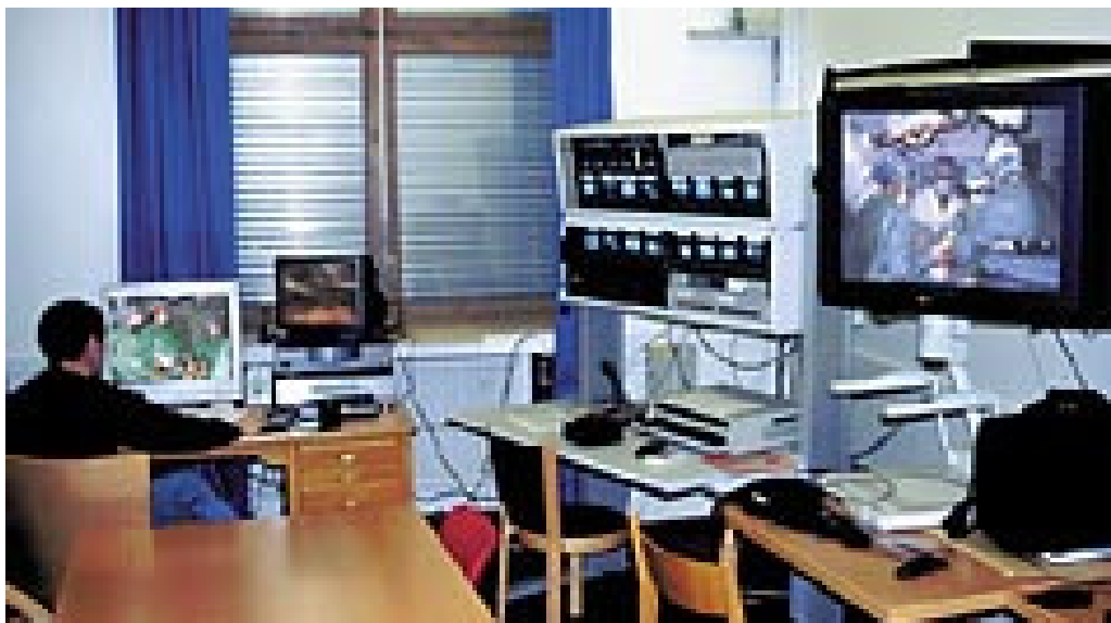
Figur 1 Kontrollrommet ved Intervensjonssenteret for telemedisinsk kommunikasjon. Overføring av inntil 16 skjermbilder og lydkommunikasjon fra operasjonsstuer eller auditorier kan kontrolleres for videresending (ISDN, ATM eller satellitt) eller for opptak til multimedieproduksjon
